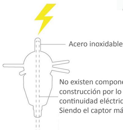
No existen componentes electrónicos en su construcción por lo tanto siempre hay continuidad eléctrica entre la punta y la tierra. Siendo el captor más robusto del mercado.
